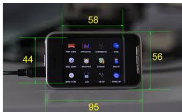
Fig. 4. Board computer „Infoboard“, „touch screen“ version
