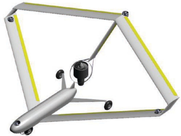
Фиг. 4. Технологичен демонстратор на електрически VTOL самолет със съчленено крило
