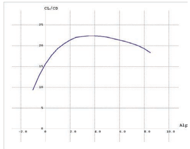
Фиг. 5. Зависимост на аеродинамичното качество от ъгъла на атака при постоянна подъемна сила на един от изследваните модели в XFLR5
