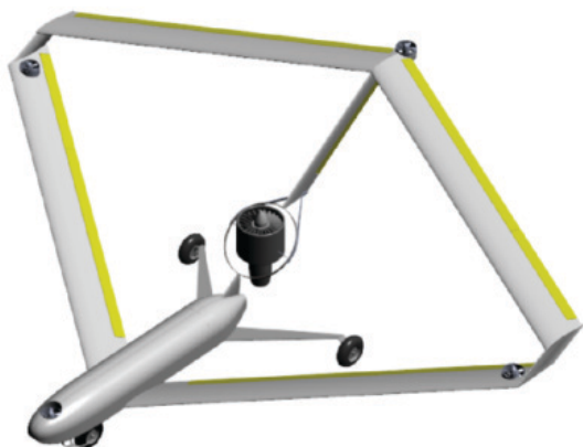
Фиг. 4. VTOL електрически безпилотен самолет със съчленено крило
