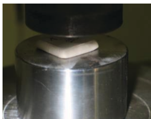
Фиг. 1. Порцеланова плочка в зоната на натиск на машината.
