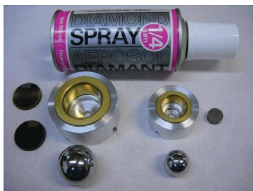
Фиг. 3. Общ вид на различни корпуси за калотест, стоманени сфери, образци и флакон диамантен спрей.
