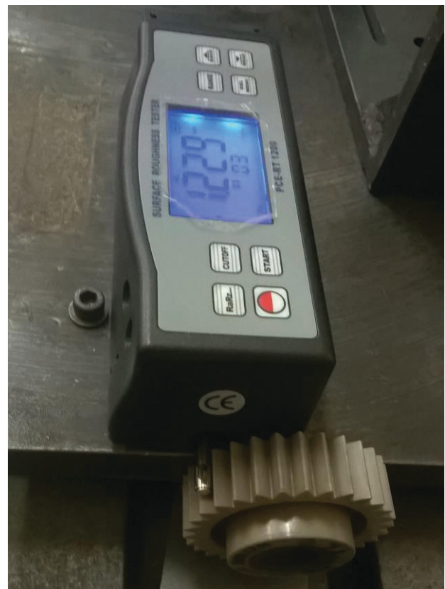
Фиг. 5. Измерване на грапавост.
