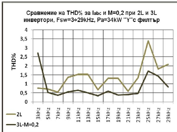
Фиг.11 Разпределение на хармоничния състав при 2L и 3L инвертори за M=0,2 и филтър.
