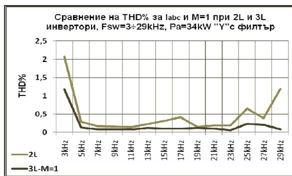
Фиг.9 Разпределение на хармоничния състав при 2L и 3L инвертори за  $M=1$  и филтър.
