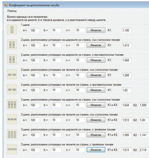
Фиг. 11. Изглед на работния прозорец на програмата за определяне на коефициента на допълнителните загуби.
