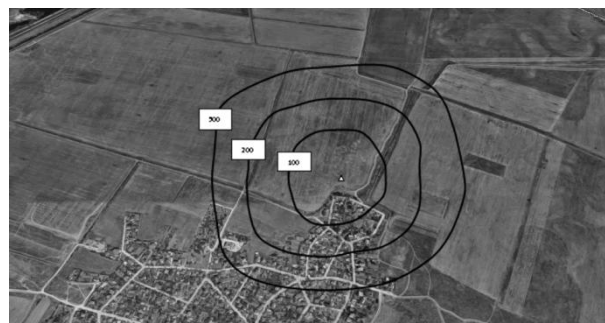
Фиг.3. Зони за подавяне при височина на полета на БЛА 100 м, 200 м и 500 м
