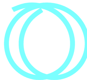
Фиг. 5. Следа от светло синята пластинка обработваща равнинна повърхнина на разположена централен ъгъл \xi=120^\circ
