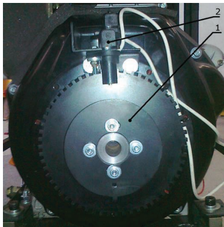
Фиг. 6. Разположение на индуктивния сензор за ГМТ 1 – диск с един зъб; 2 – индуктивен сензор.
