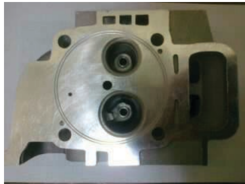
Фиг. 12. Разположение на отвора в цилиндровата глава към сензора за налягане
